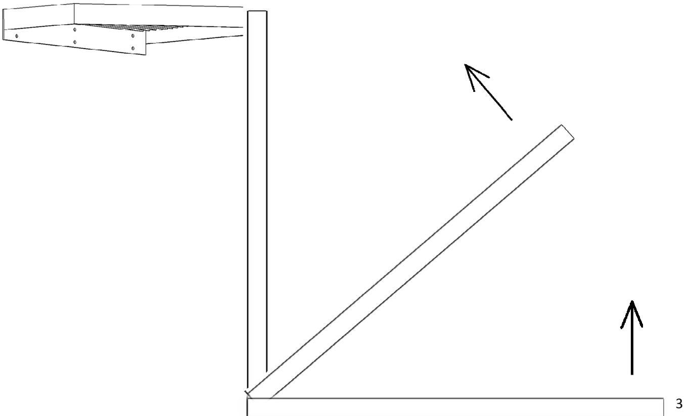
4. Die Stufen in der Reihenfolge von der ersten bis zur letzten mit den an der Säule angeschraubten Muttern M20 anschrauben. Die Muttern vorerst nur leicht anziehen.
