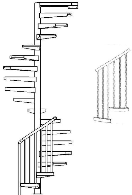
6. Das Geländer auf dem Podest auf den restlichen Podestdorn aufchieben und den Aufsatz mit den Halbrundkopfschrauben M8x20 an die Säule schrauben. Den unteren Geländerwinkel mit Halbrundkopfschrauben M10 und Muttern M10 zum Podest zuschrauben.
