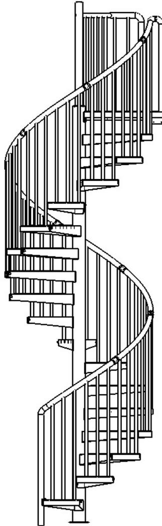
7. Abschließend alle Muttern M20, welche die Stufen und das Podest befestigen, nachziehen, die Schrauben der Geländerverbindungen nachziehen und alle Schraubenverbindungen auf Festigkeit prüfen. Soweit irgendwo Zinkgrate vorkommen, sind diese mit Schleiftuch oder Feile abzuschleifen.
